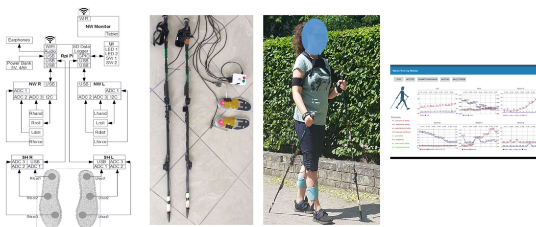
Rys. 1. Schemat funkcjonalny, widok systemu mechatronicznych kijów NW, widok amatorki podczas chodu oraz okno aplikacji mobilnej z wizualizacją on-line parametrów marszu NW
